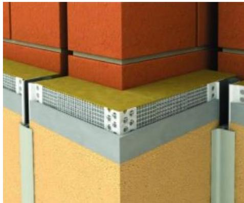
Antes del enlucido de los paneles aislantes, es necesario proteger el sistema aplicando protecciones en todas las aristas. Para ello, utilizaremos el tipo de perfil necesario en cada caso.
